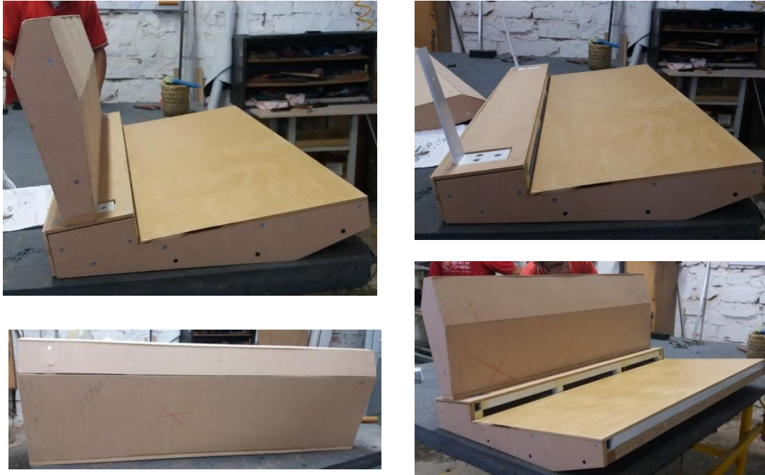
Figura 44. Estructuras armadas, listas para ser espumadas.
