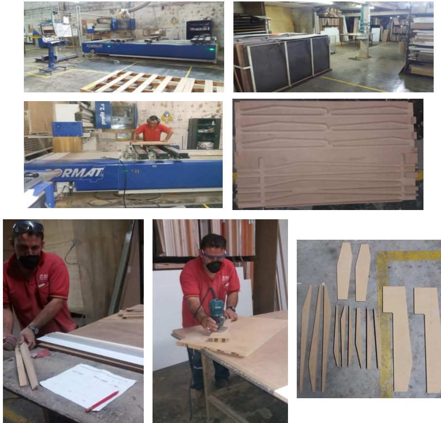
Figura 42. Centro de mecanizado de piezas madera.
