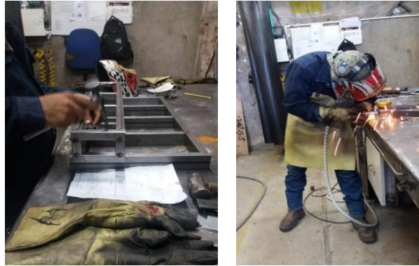
Figura 34. Armar y soldar las piezas estructuras internas del sofá.
