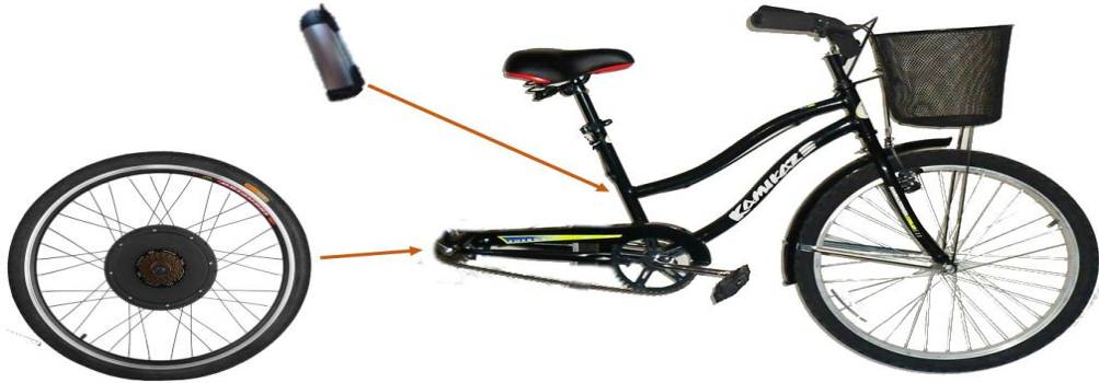
Figura 14. Ensamble de las partes que componen un bicimotor de ME.
