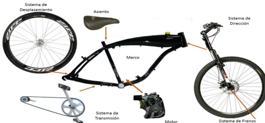
Figura 15. Ensamble de las partes que componen un bicimotor de MCI.
