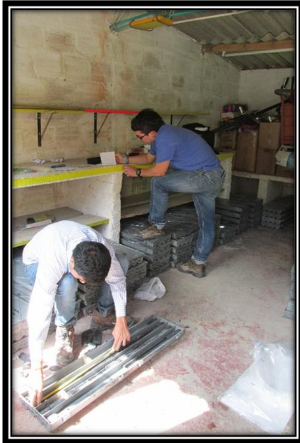
Figura 9. Procedimiento para confirmar la recuperación de núcleo.
