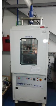
Figura 30. Equipo NAT HYD25-II (MPI) empleado en tracción indirecta.
