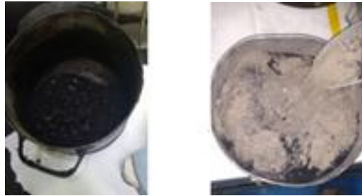
Figura 31. Elaboración de mezcla homogénea y mezcla de agregados con GCR.
