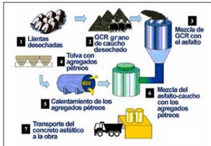
Figura 3. Proceso adición del GCR al asfalto por vía húmeda.
