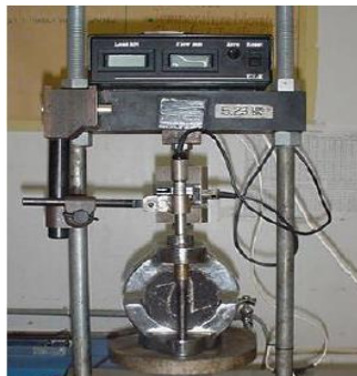
Figura 4. Aparato estabilidad de Marshall.
