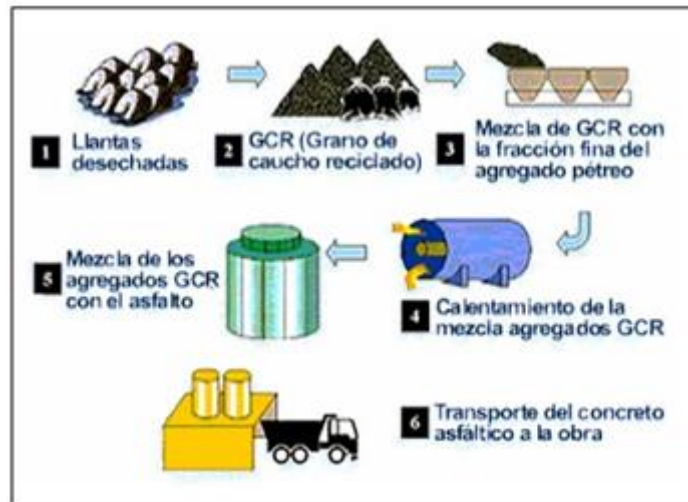
Figura 2. Proceso adición del GCR al asfalto por vía seca.
