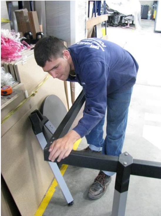
Figura 89. Ensamble de las vigas en el herraje de unión a 90°
