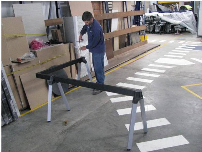
Figura 90. Ensamble y ajuste del tercer pedestal con la viga.
