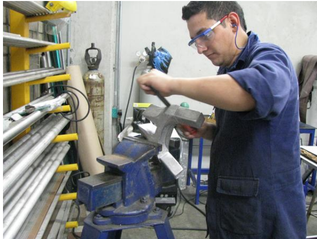
Figura 45. Limado de la pieza fundida.
