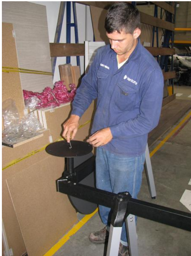
Figura 94. Instalación del disco metálico del dispositivo para superficie elevada.
