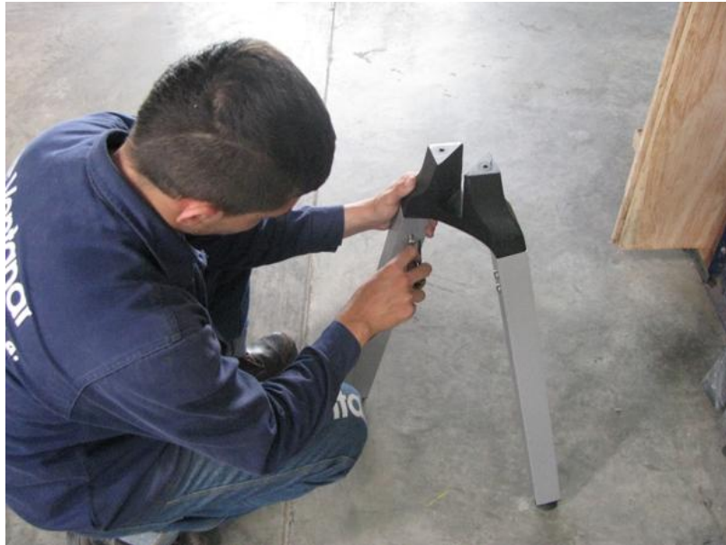
Figura 85. Ensamble de los parales en la cadera del pedestal.
