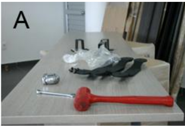
Figura 13. Herramientas para instalar un puesto Klass: A. Maso y llave de boca mixta. B. Llaves bristol.
