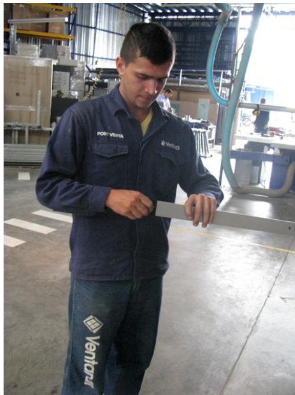
Figura 84. Colocación de los tapones en los tubos de los pedestales.
