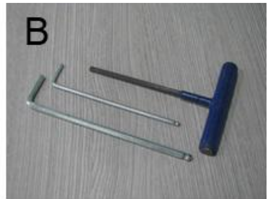
Figura 13. Herramientas para instalar un puesto Klass: A. Maso y llave de boca mixta. B. Llaves bristol.
