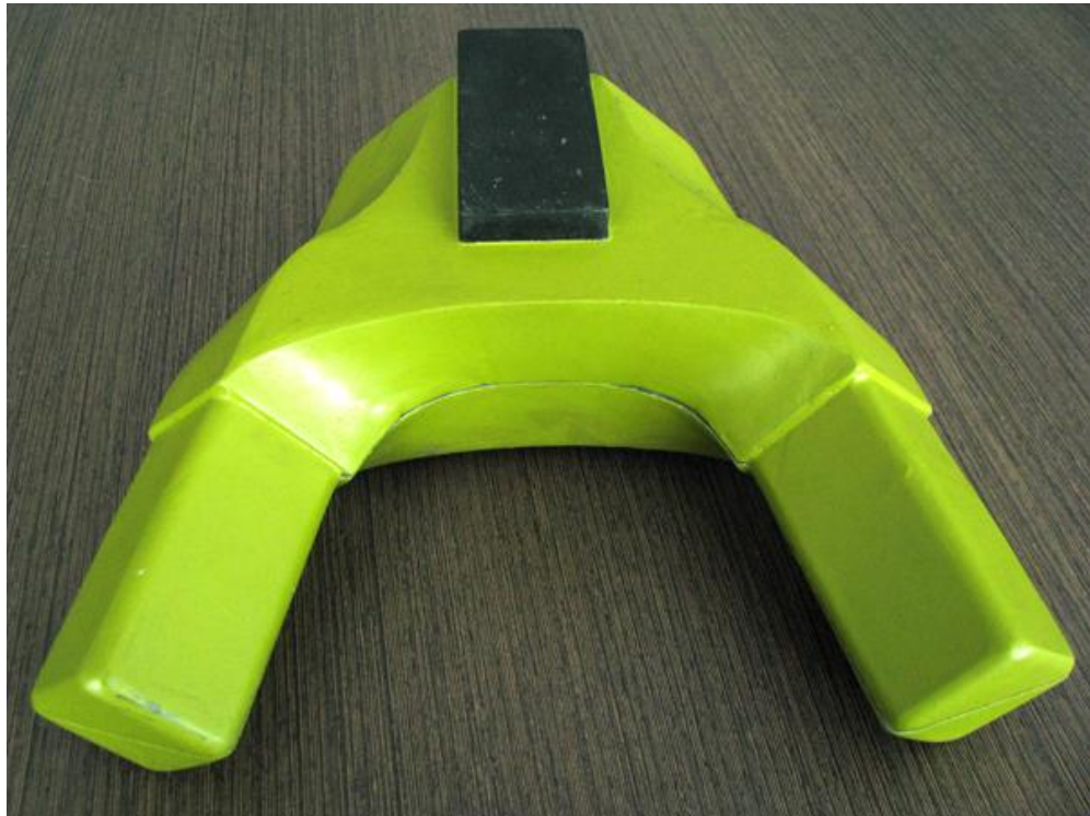
Figura 44. Modelo de fundición modificado.
