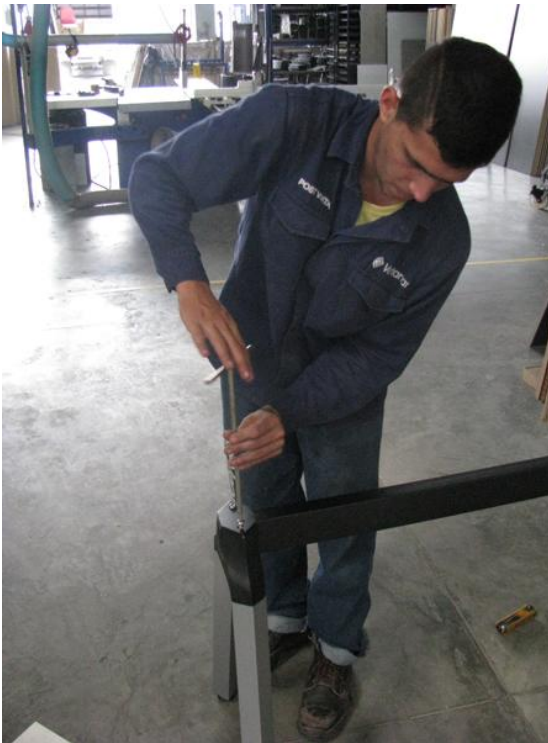
Figura 88. Ajuste de los tornillos en la tapa del pedestal.
