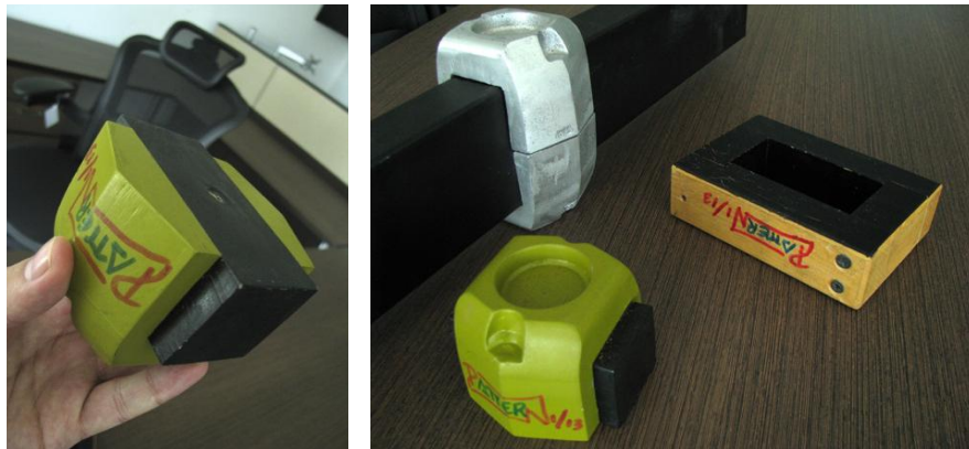
Figura 75. Modelo de fundición para las mordazas.
