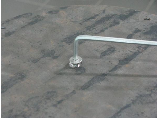
Figura 79. Tornillo avellanado que sujeta el disco HR al buje.
