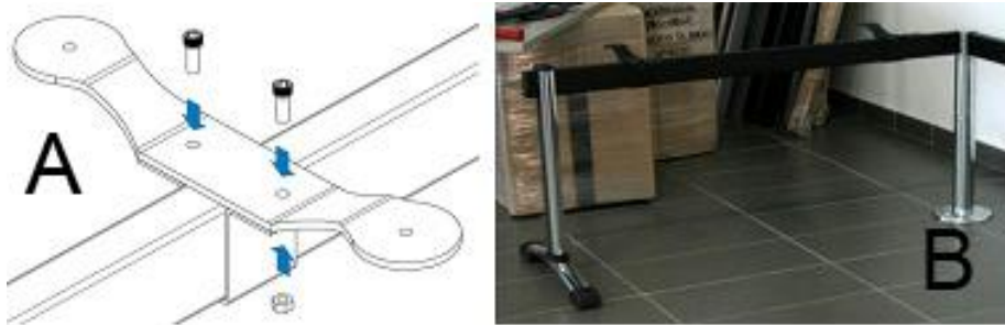
Figura 16. Instalación del brazo Klass sobre la viga.
