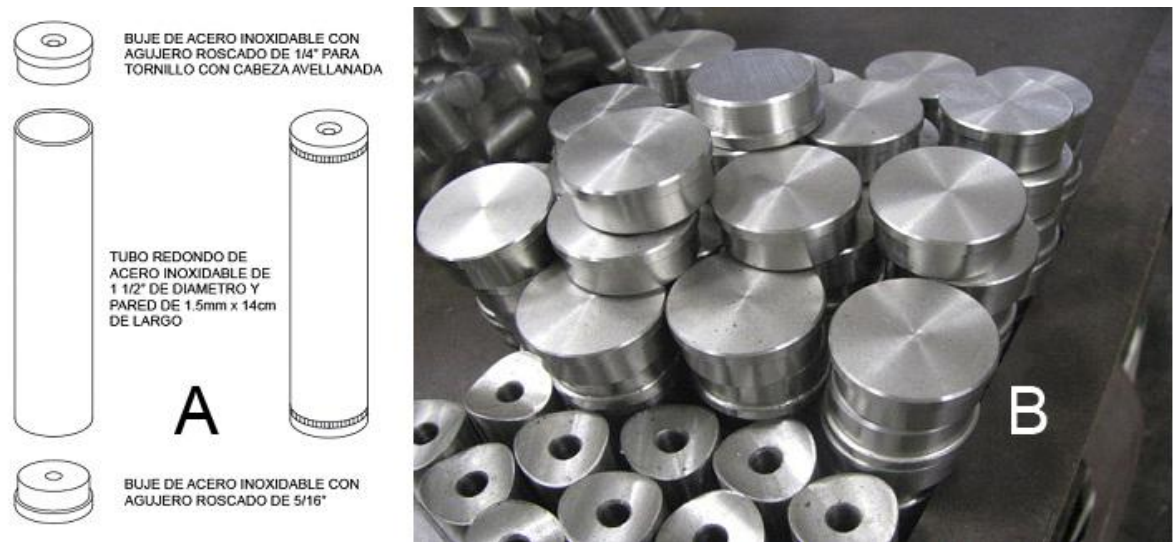
Figura 77. Bujes de acero inoxidable: A. Ensamble dentro del tubo. B. Pila de bujes en el taller de maquinado de Ventanar.
