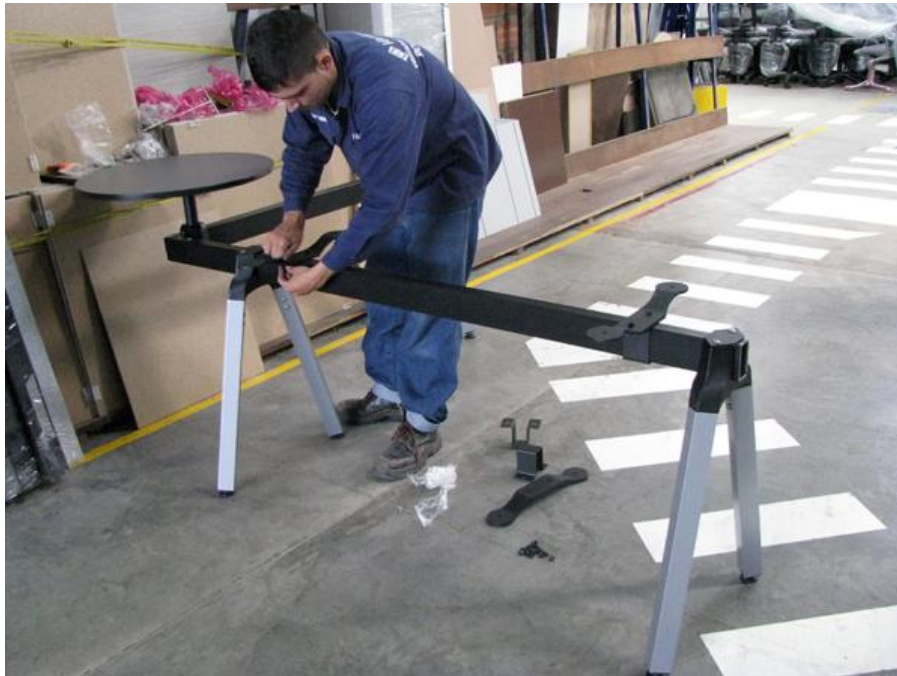
Figura 96. Armado de los brazos klass.
