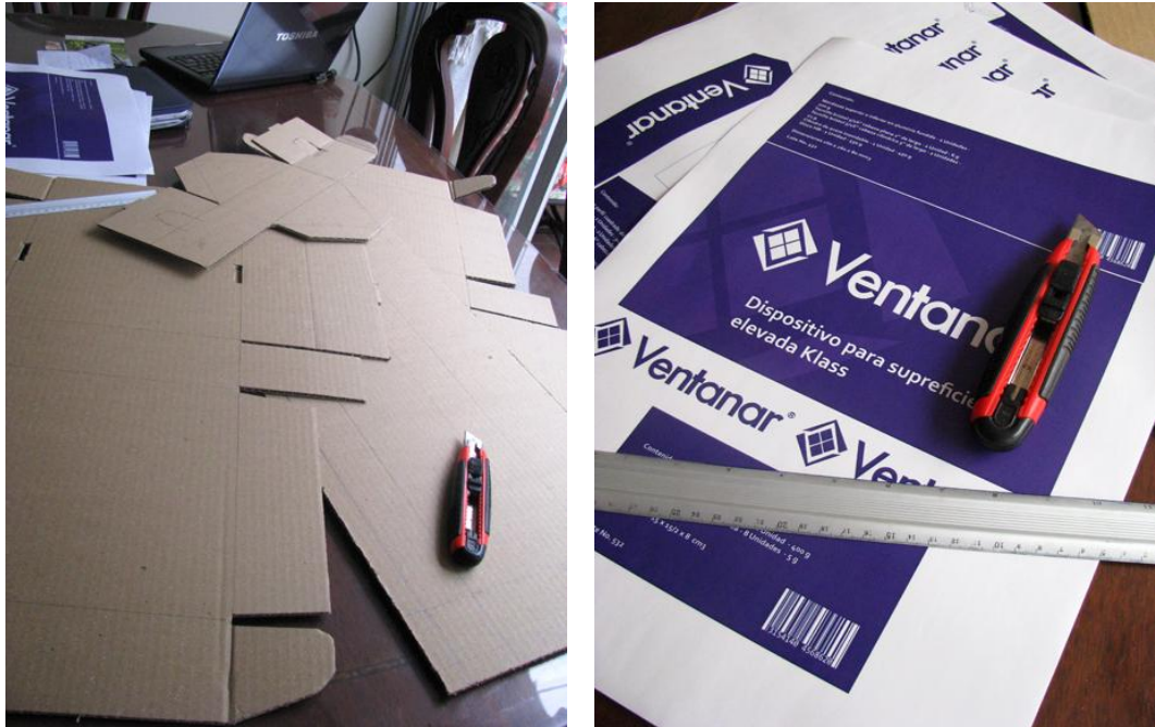
Figura 110. Corte de los desarrollos y la parte gráfica de los empaques.
