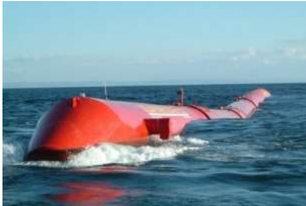
Figura 4. Dispositivo atenuador Pelamis
