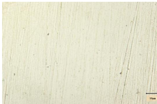
Figura 13. Superficie de Zn inmersa en NaCl [0.1M] a 10X en ensayo de pérdida de masa después de 49 horas de exposición.
