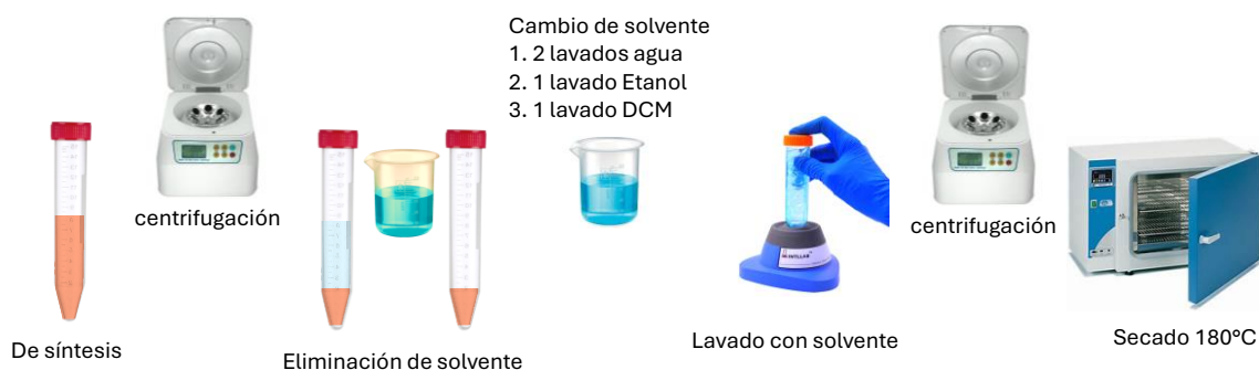
Figura 109. Proceso de lavado de NPs óxidos de Fe, en síntesis
