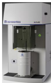
Figura 14. Analizador de área superficial 3FLEXTM (Micromeritics)
