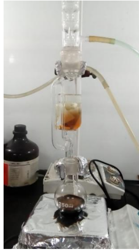
Figura 110. Montaje para la extracción de asfaltenos de crudo Rubiales
