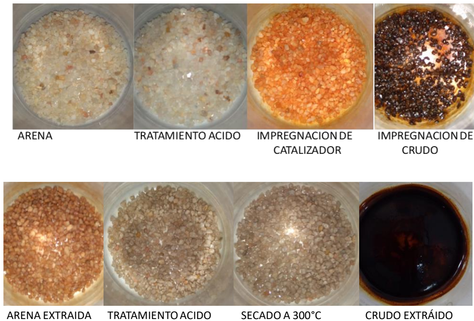
Figura 85. impregnación de catalizador y crudo en arena
