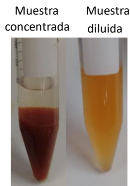
Figura 28. Dispersión de NPs en gel y dispersión de partículas diluidas
