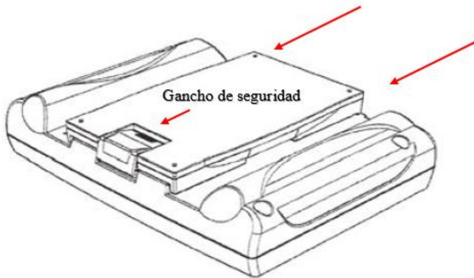
Figura 1.6. Esquema de la conexión de la batería.
