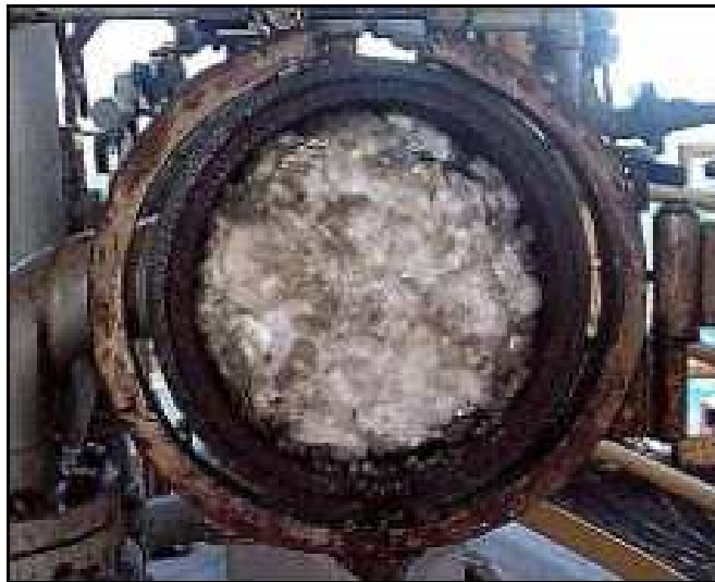
Figura 15. Bloqueo de la línea debido a la formación de hidratos
