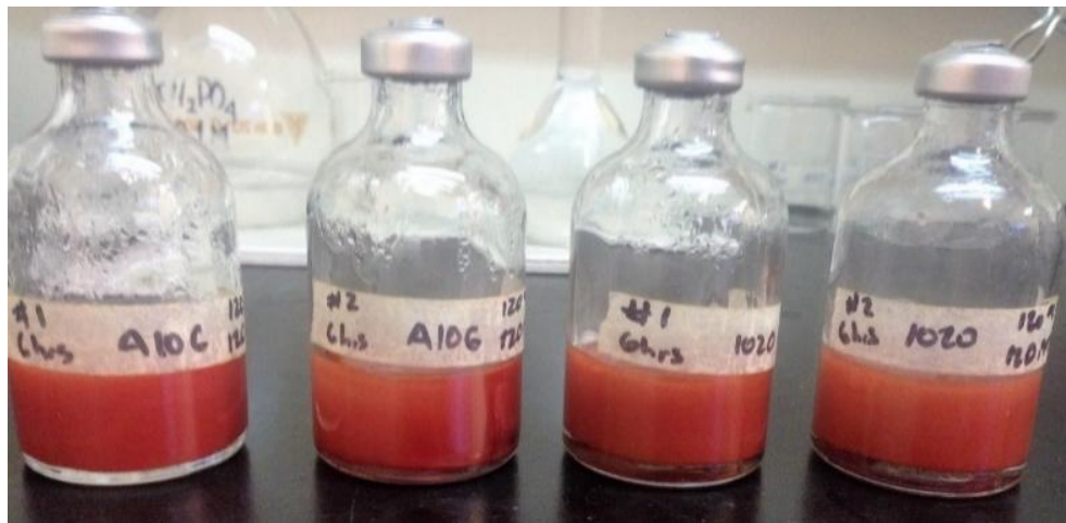
Figura 11. Medio corrosivo después de las pruebas gravimétricas a T: 120 °C
