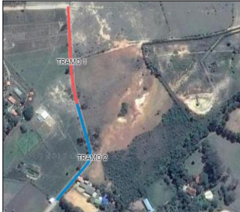
Figura 7. Tramo 1 estabilizado con cemento y tramo 2 estabilizado con aditivo líquido.
