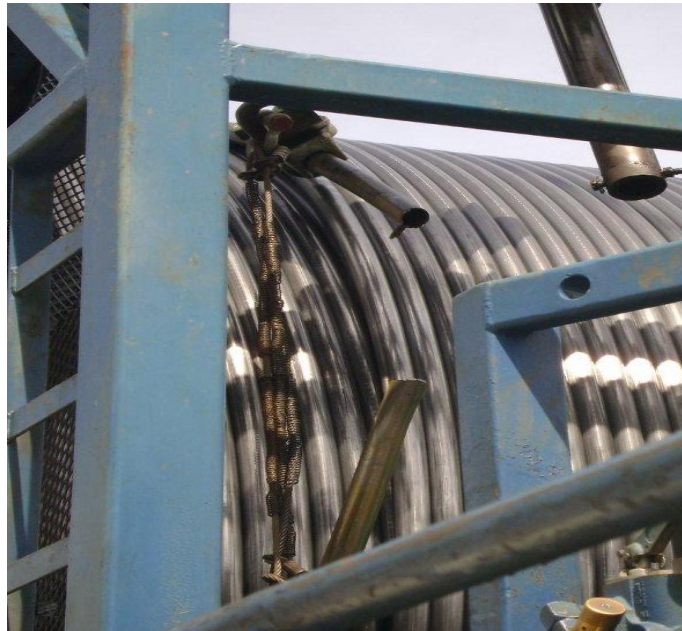
Figura 88. Tubería rota y enrollada en el carrete
