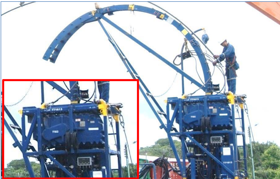
Figura 14. Sistema de motor y freno de la cabeza inyectora
