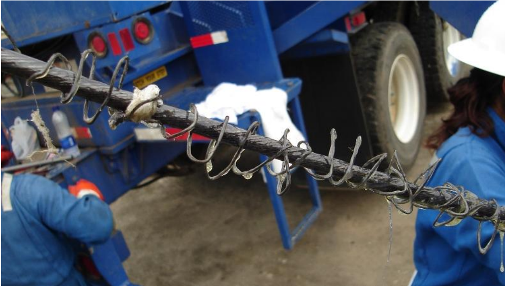
Figura 97. Armadura externa suelta
