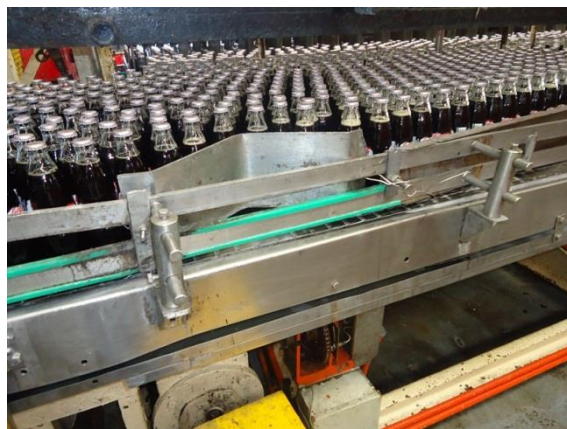
Figura 16. Rompeolas, distribución y transferencia de botellas.
