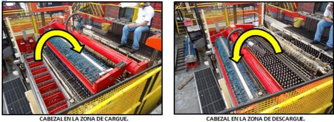
Figura 4. Ciclos operativos de la máquina empacadora.
