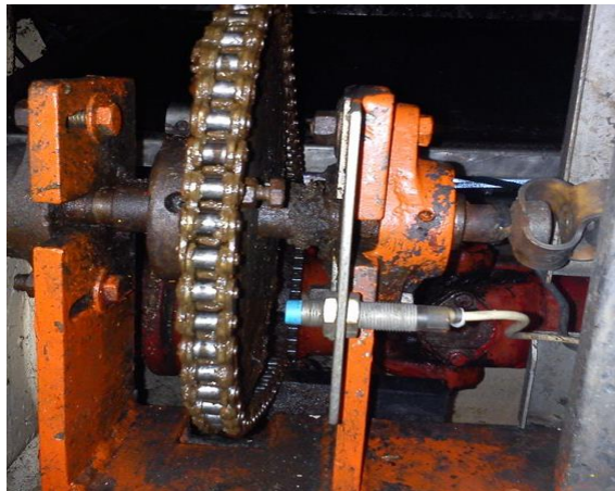
Figura 25. Sistema de transmisión, encoder y sensor inductivo.
