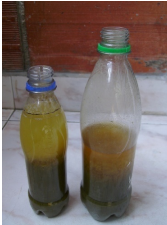
Figura 52. Muestras de Mucílago de Fique con Aldacide (frasco grande) y sin Aldacide (frasco pequeño) al momento de la Adición del Aldacide G.
