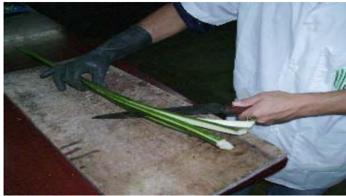
Figura 33. Cortes Realizados a la Hoja de Figue para Facilitar el Proceso de Prensado en la Maquina Berstor AF.
