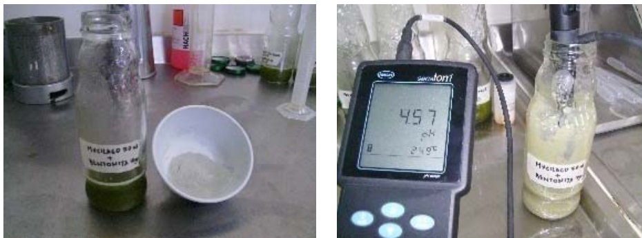
Figura 44 y Figura 45. Muestra 2. Mucílago de Figue (50 ml) + Bentonita (10 gr) y Toma de pH. Fuente: Los Autores
