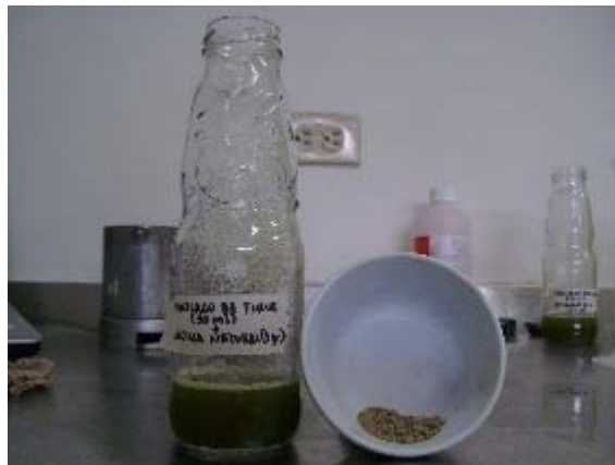
Figura 47. Muestra 4. Mucílago de Fique (50 ml) + Arcilla Natural (3 gr) Fuente: Los Autores
