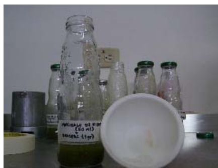
Figura 50. Muestra 7. Mucílago de Figue (50 ml) + Drispac (1 gr) Fuente: Los Autores
