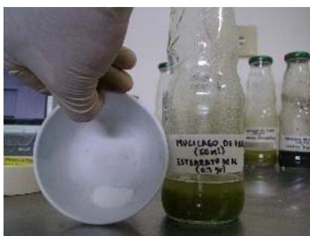
Figura 49. Muestra 6. Mucílago de Figue (50 ml) + Estearato de Aluminio (0,1 gr) Fuente: Los Autores
