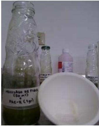
Figura 51. Muestra 8. Mucílago de Figue (50 ml) + Pac-R (1 gr) Fuente: Los Autores
