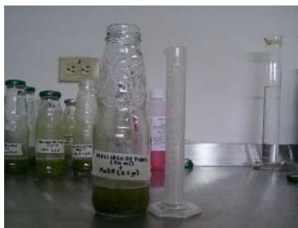
Figura 48. Muestra 5. Mucílago de Figue (50 ml) + NaOH (0,5 gr) Fuente: Los Autores
