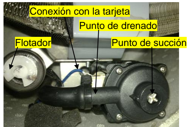
Figura 49. Bomba de drenado
