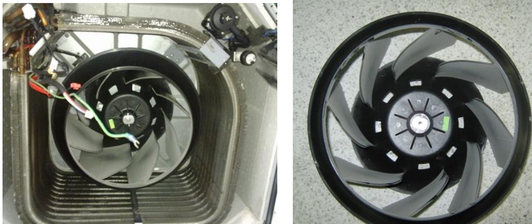
Figura 51. Ventiladores tipo turbina
