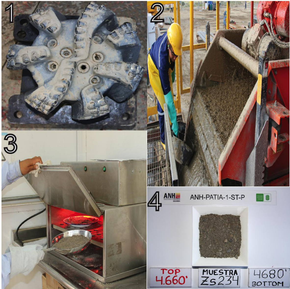
Fotografía 2. (1) Broca de perforación convencional, (2) lodo de perforación con ripios, (3) secado en horno de las muestras de zanja y (4) producto final.
