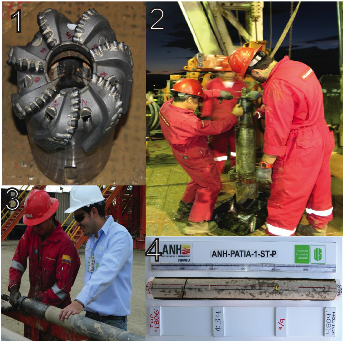
Fotografía 1. (1) Herramienta corazonadora, (2) bajando herramienta para iniciar corazonamiento, (3) extracción del núcleo del barril corazonador y (4) Producto final.
