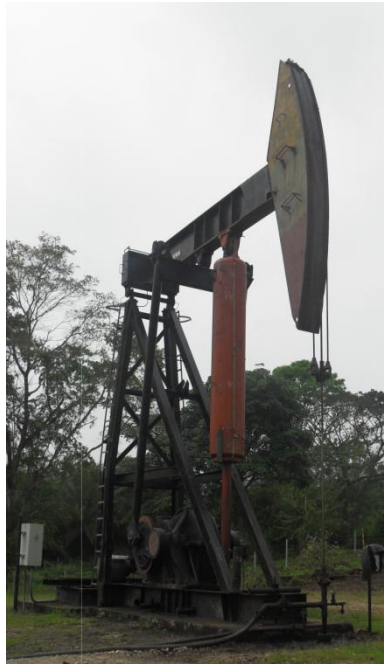
Figura 8. Unidad de bombeo balanceada con aire
