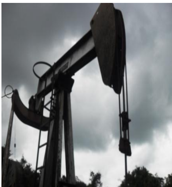
Figura 6. Unidad de bombeo convencional
