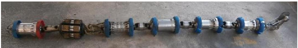
Figura 8. Herramienta utilizada para la inspección MFL+XYZ gasoducto Bucaramanga-Payoa 6"
