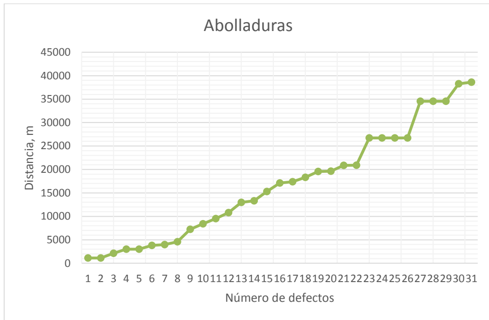
Figura 62. Número de defectos por abolladuras durante el recorrido de la tubería 06" Payoa - Bucaramanga
