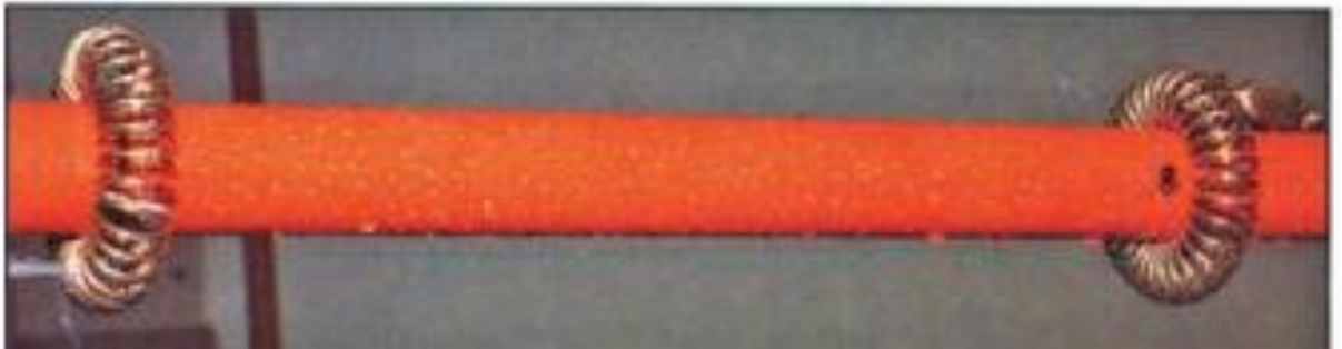
Figura 9. Montaje para prueba eléctrica de pértiga por medio de electrodos.
