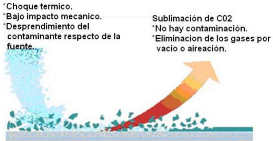
Figura A.1. Limpieza de aisladores contaminados con Pellet de CO 2 .
