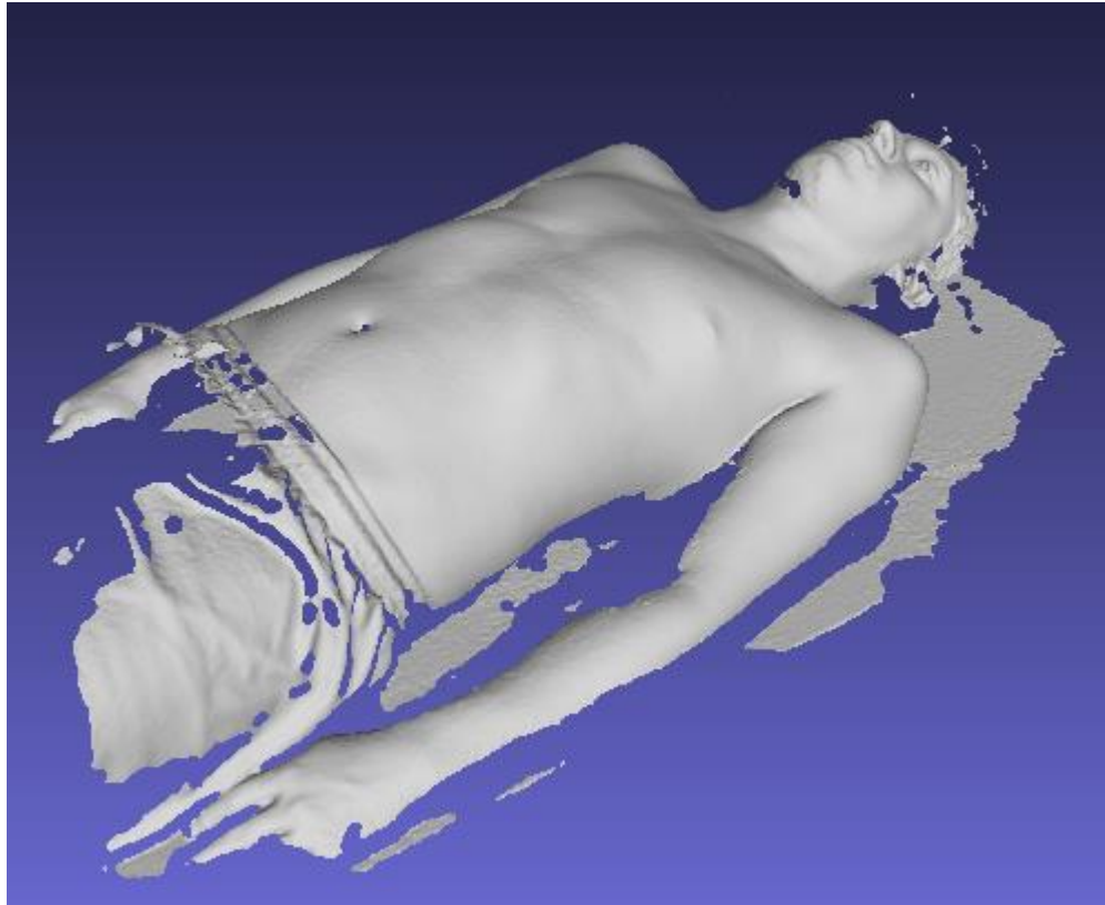
Figura 45. Malla de referencia, obtenida mediante el GoScan.
