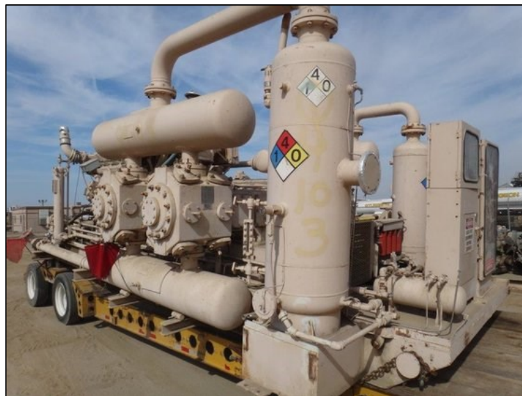
Figura 24. Compresor Dresser Rand 4 RDS
