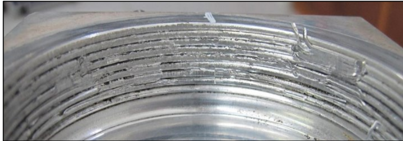
Figura 49. Daño en los hilos de la rosca interna del Hoop (Aspa 2).
