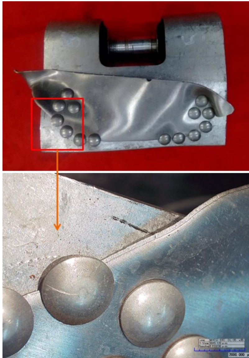
Figura 51. Rotura en lámina del Aspa 5.
