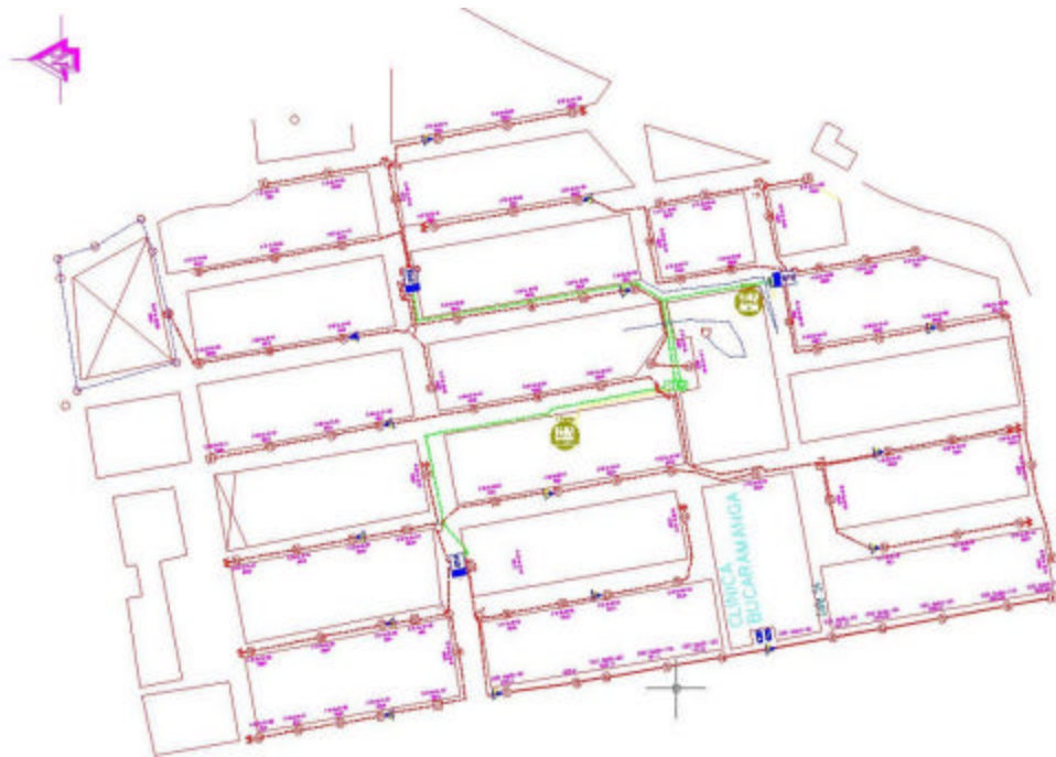
FIGURA 2. PLANO DWG ACTUAL DE UNA RED DE TV POR CABLE
