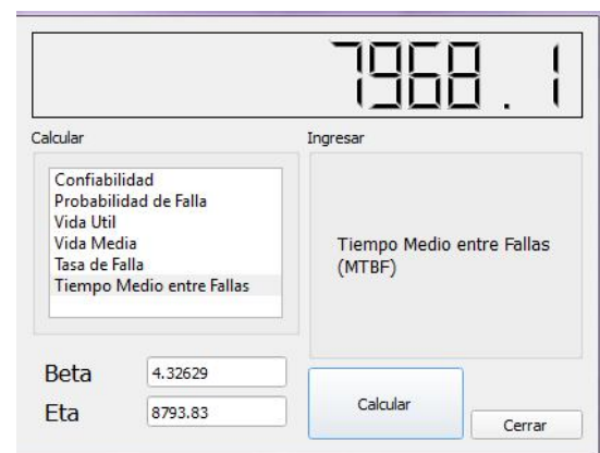
Figura 23. Cambio de filtro de aire MTBF
