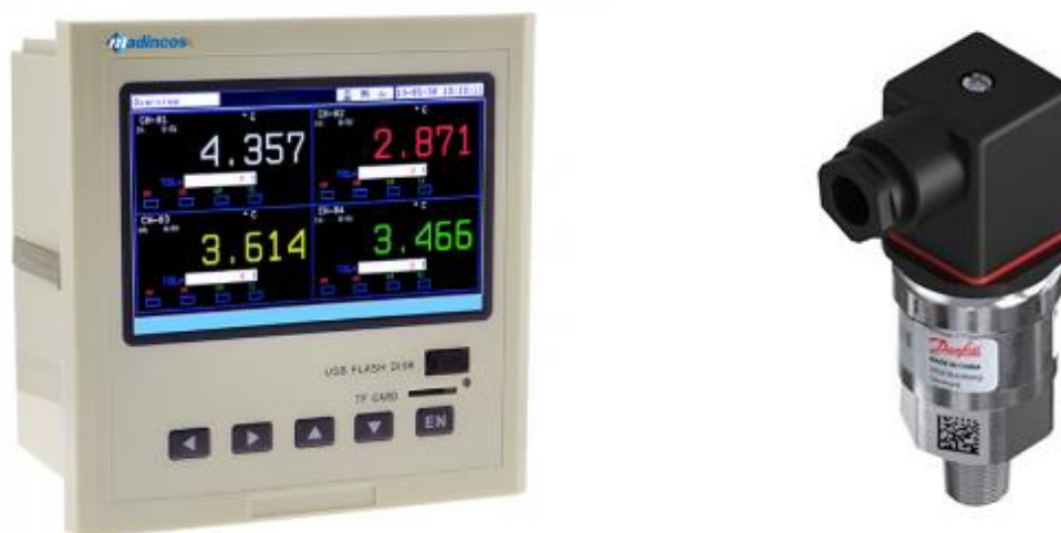
Registrador de datos - Madincos MPR4200. Transductor de presión - Danfoss MBS 3000 060G1107.
