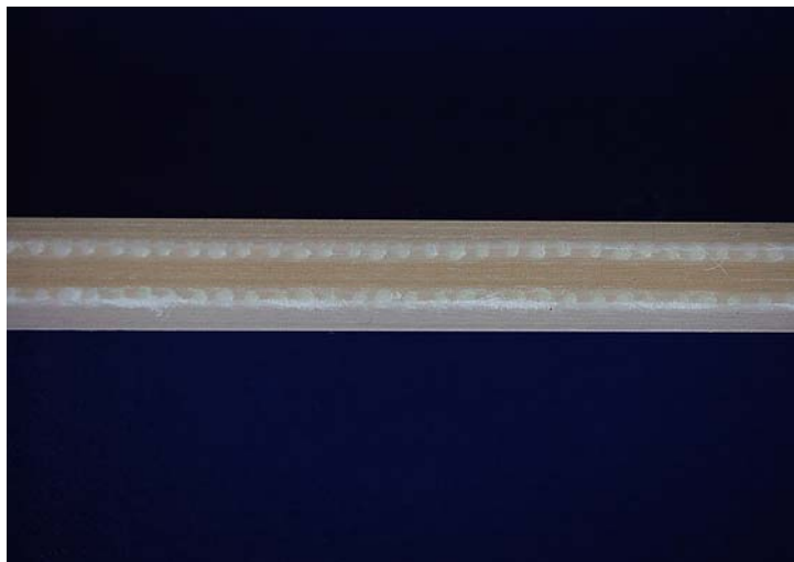
Figura. (b) Espesor de probeta definitivo para el ensayo de tracción
