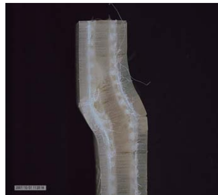
Figura. (e) Fotomicrografía de la falla del material
