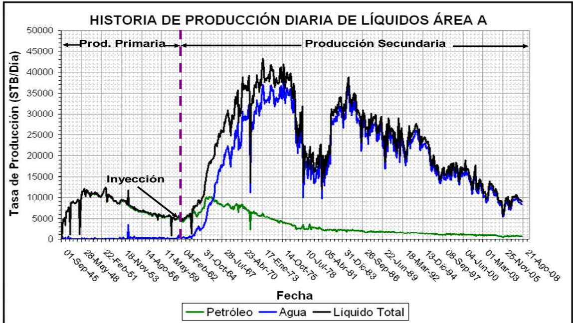
Figura 11. Producción histórica del petróleo, agua y líquido total del área A del Campo Tibú.
