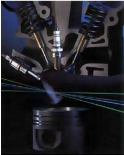
Figura 22. Bosch esta desarrollando diversos componentes para optimizar la inyección directa de gasolina. La fotografía de la izquierda muestra el análisis de la formación de la mezcla aire/combustible utilizando la tecnología de medición de láser
