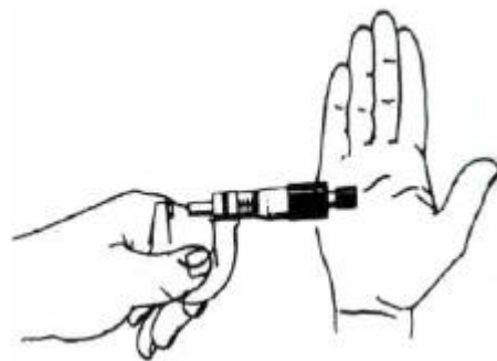
Figura 15. Haga rotar el casquillo sobre su mano para que la boca móvil realice movimientos extensos (ilustración cedida por C. Thomas Olivo Associates, Fundamentals of Machine Technology).
