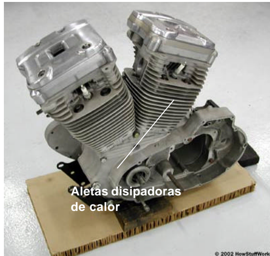
Figura 4, Motor dos tiempos de motocicleta, refrigerado por aire ¶ .
