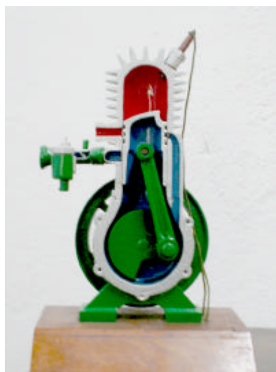
Figura 58 Mejoramiento motor de dos tiempos en corte
