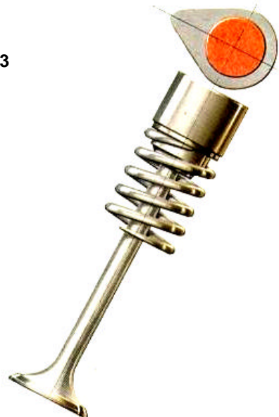
Figura 35c. Válvula en cabeza con el árbol de levas directamente encima. Este es el método más eficaz. En los motores modernos se va haciendo general por la eficacia de su acción.
