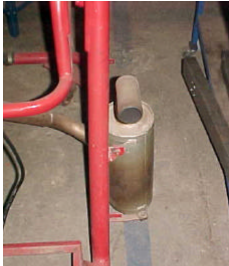
Figura 11. Foto del tubo de escape y silenciador
