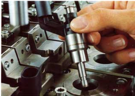
Figura 15 ® . Instalación de los inyectores dentro de la culata.
