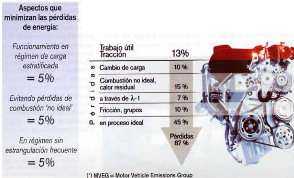
Figura 17. Aprovechamiento de la energía en motores de gasolina funcionando según normas de ciclo MVEG
