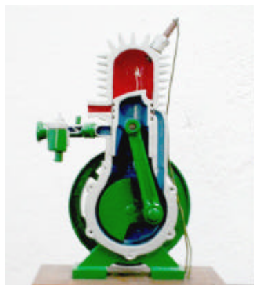
Figura 20 Modelo de un motor de dos tiempos en corte
