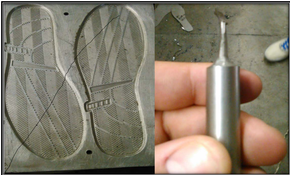
Figura 4. Tallado y herramienta de mecanizado
