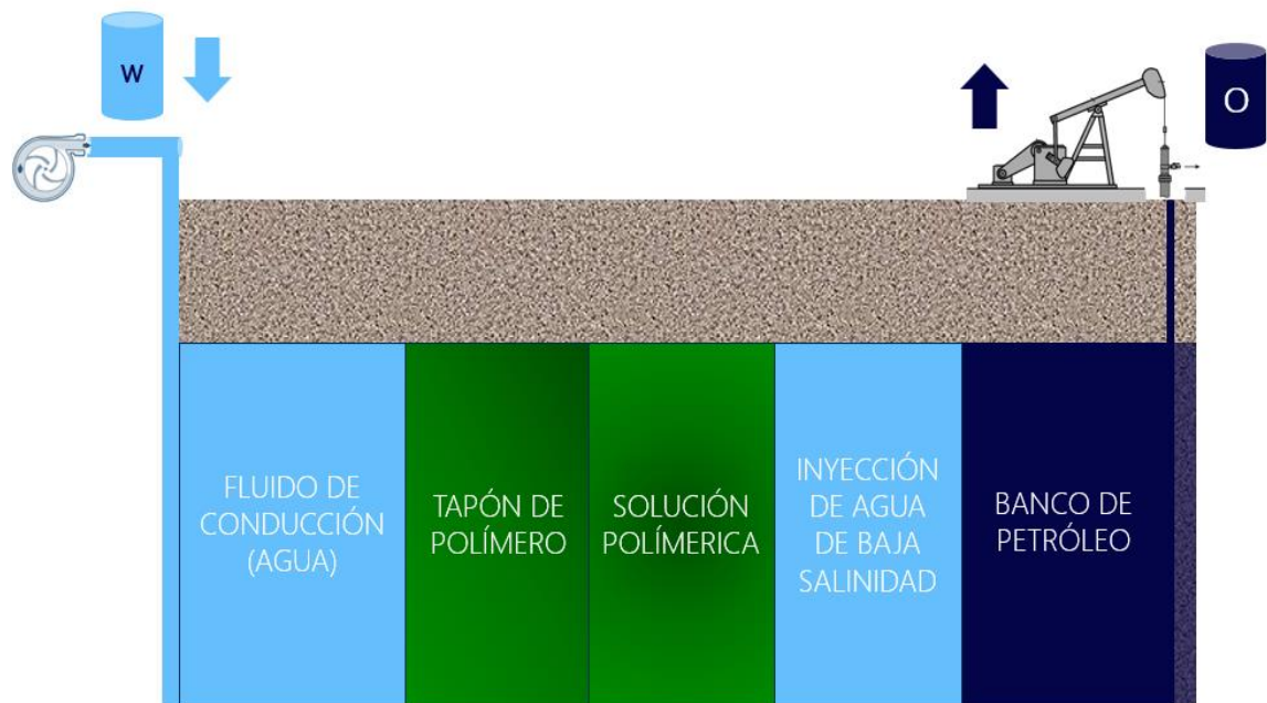
Figura 1. Proceso de inyección de polímero
