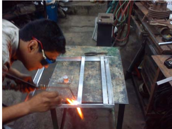
Figura 46. Soldadura de la base
