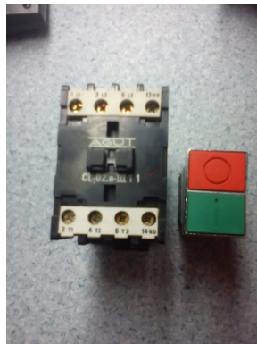
Figura 49. Pulsador y Contactor
