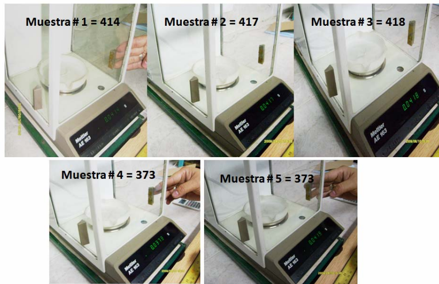
Figura 15. Medición del titulo para el hilo
