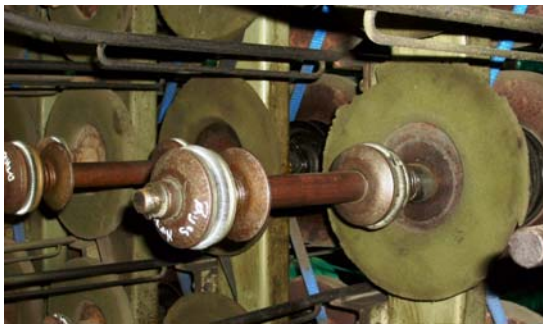
Figura 28 Puesto de la fileta sin bobina y con bobina
