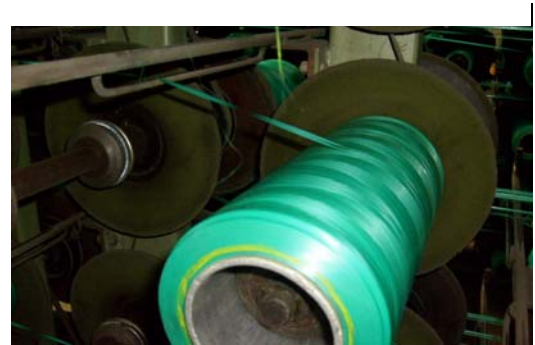
Figura 28 Puesto de la fileta sin bobina y con bobina
