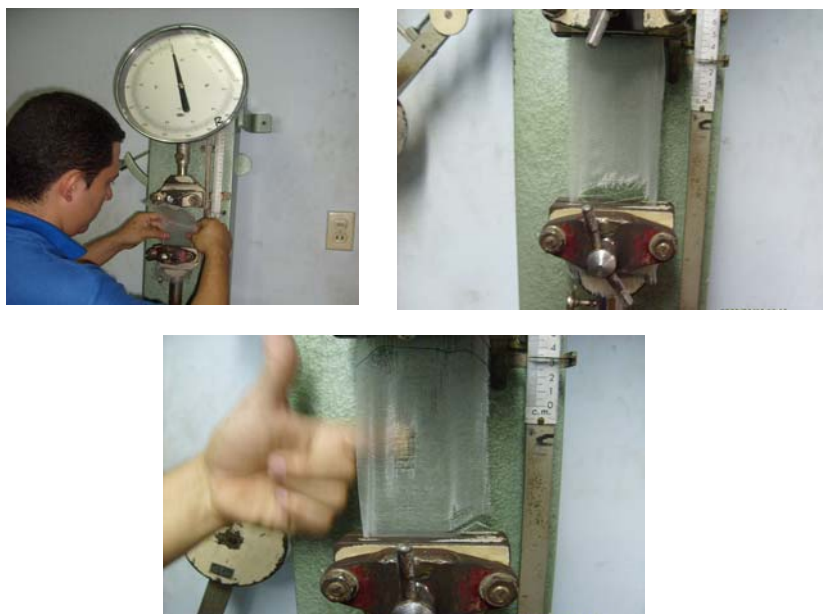
Figura 20. Pruebas de la malla en el dinamómetro
