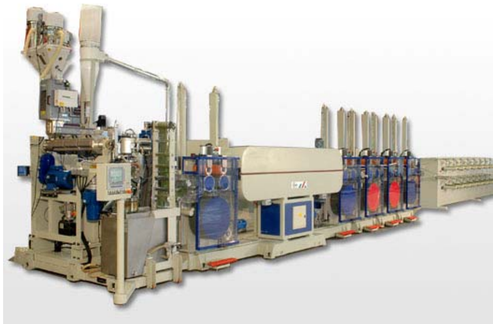
Figura 31. Foto de la extrusora de Sima Group
