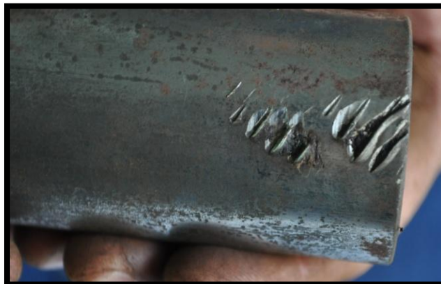
Fig. 60. Acople de Varilla con daños superficiales
