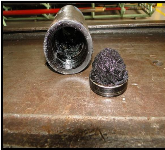
Fig. 12. Arena en la válvula Viajera
