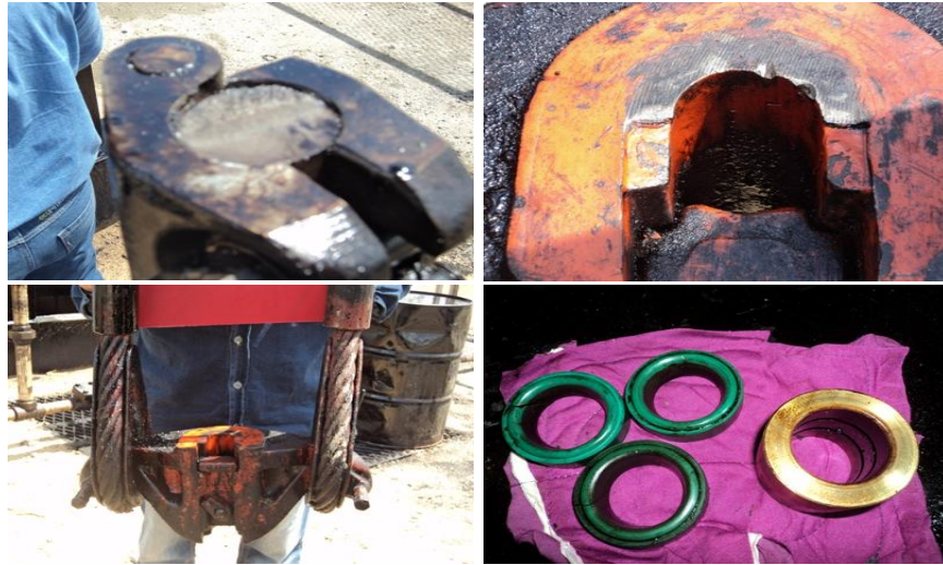
Fig.45. Carrier Bar y Grapa. Falla en Barra Lisa Pozo BC 199
