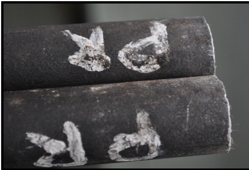
Fig. 39. Varilla Partida Pozo BC 870 Vista Lateral
