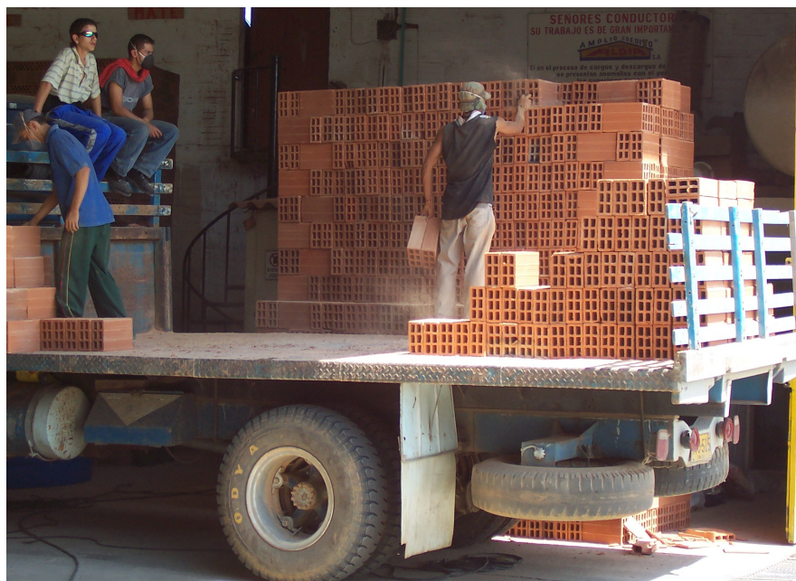
Figura 7. Descarga Manual de Ladrillos
