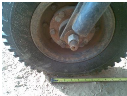
Figura 81. Medición del coeficiente de resistencia a la rodadura.
