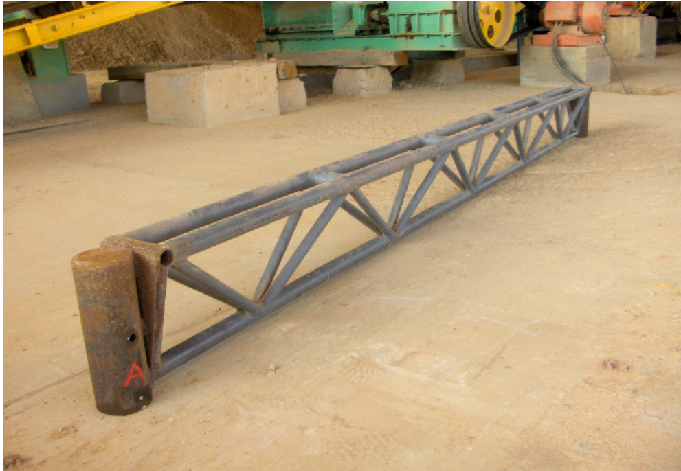
Figura 70. Viga principal completa.
