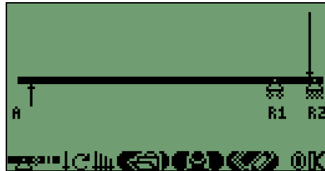
Figura 42. Diagrama de cargas para el tubo superior del telescópico.
