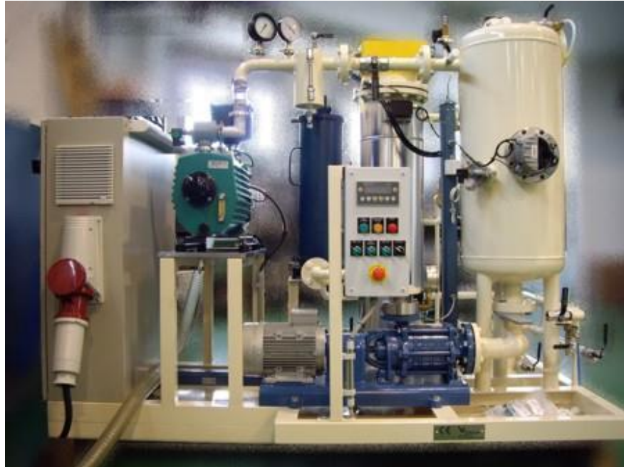
Ilustración 16. Equipo de tratamiento de aceite.
