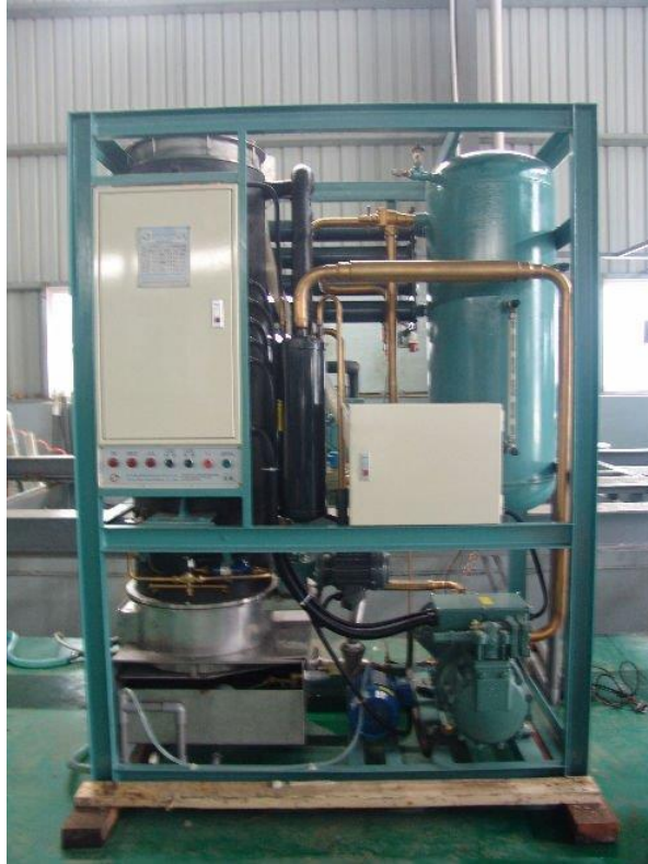
Fotografía 22. Generador de hielo en cubos Vogt
