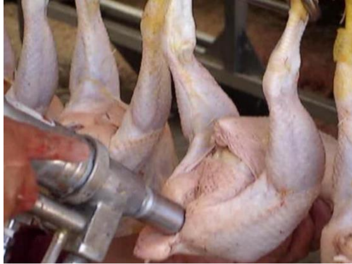
Fotografía 12. Descloacado manual con pistola neumática
