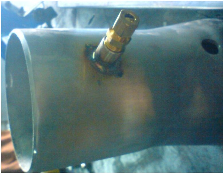
Figura 42. Soldadura con argón
