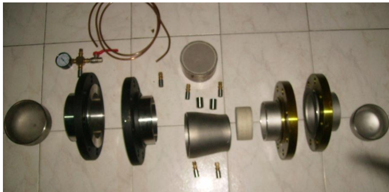
Figura 40. Distintas partes del refrigerador termoacústico
