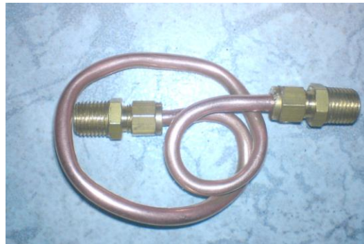
Figura 36. Intercambiadores de calor hechos en cobre
