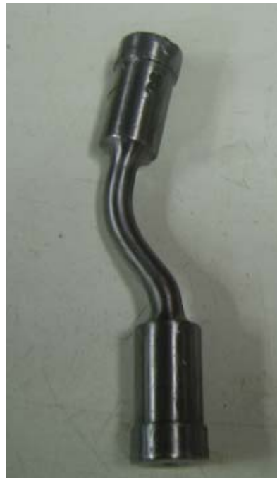
Figura 66. Falla de probeta 9 mm
