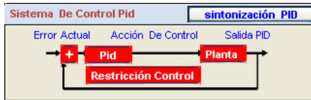
Figura 35. Estructura del control PID
