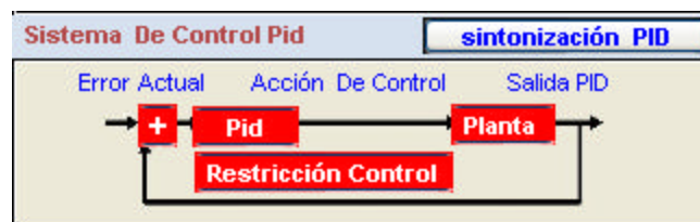
Figura 20. Estructura del control PID
