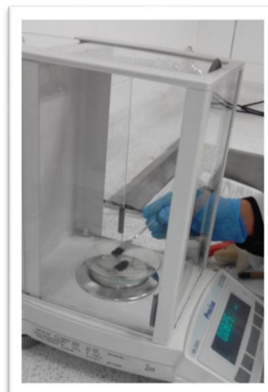
Figura 12. Centrifugación y pesado de la biomasa recuperada.
