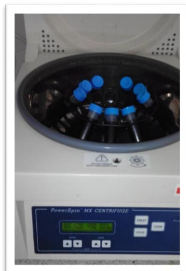
Figura 12. Centrifugación y pesado de la biomasa recuperada.
