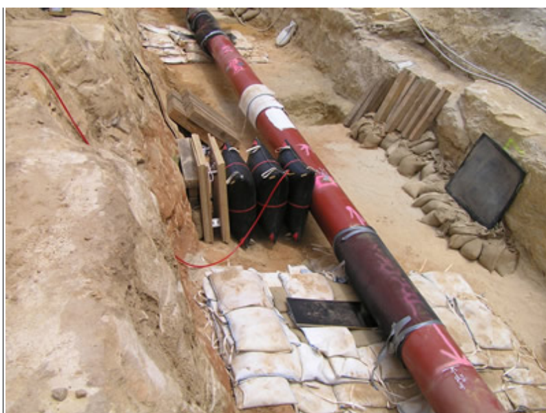
Ilustración 3.1. Instalación típica de Strain-gauges en la tubería.
