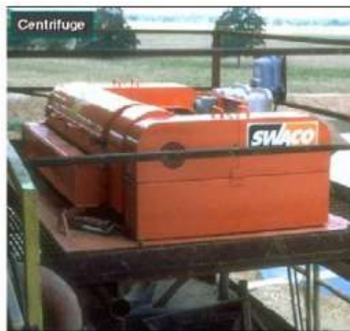
Figura 18. Centrífugas decantadoras de solidos
