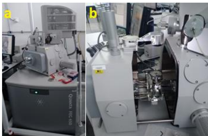
Figura 22 (a) Microscopio Electrónico de Barrido; (b) Ubicación de la muestra
