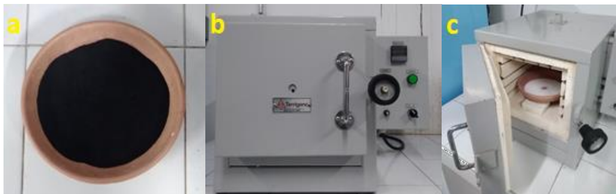
Figura 18 (a) Ceniza pre calcinada; (b) Mufla; (c) Ceniza calcinada.
