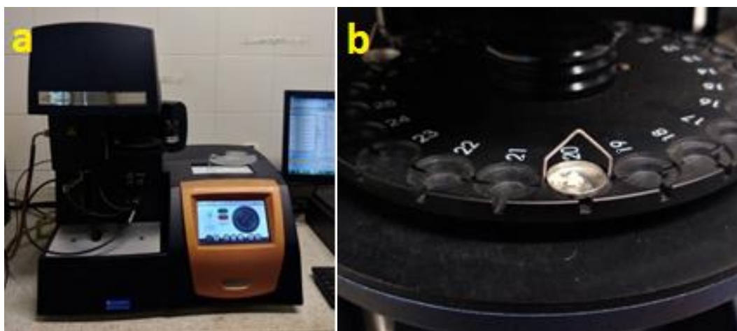
Figura 20 (a) Analizador Termogravimétrico; (b) Crisol con la muestra.
