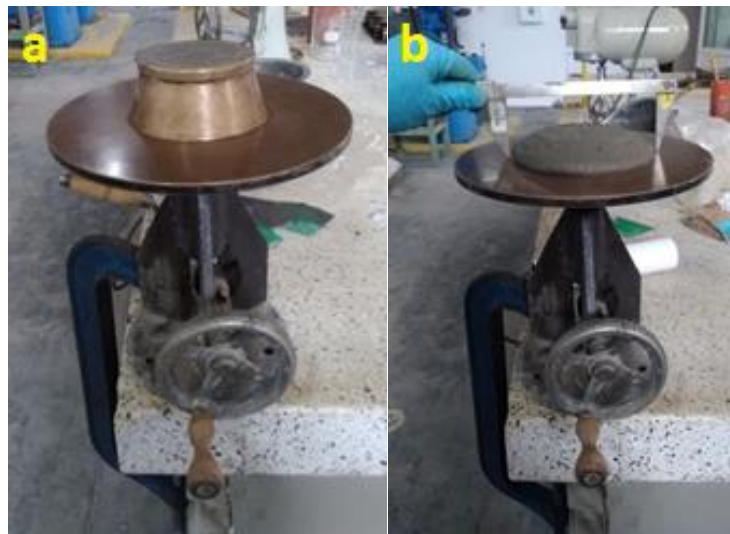
Figura 26 (a) Mesa de flujo y anillo; (b) Mesa de flujo y calibrador
