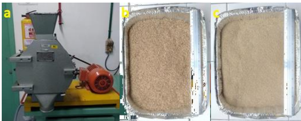
Figura 15 (a) Molino de Cuchillas; (b) Partículas tamiz 2 mm; (c) Partículas tamiz 1 mm
