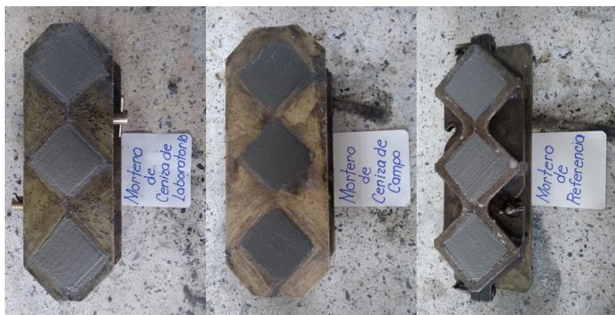
Figura 27 Cubos para ensayo de compresión
