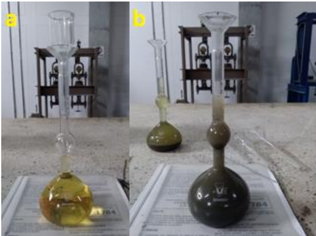
Figura 25 (a) Frasco con kerosene; (b) Frasco con kerosene y ceniza de campo
