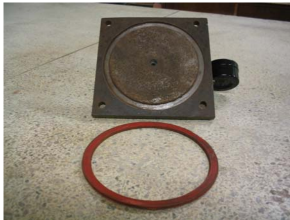
FIGURA 53. DETALLE DE LA TAPA Y EL EMPAQUE DEL MOLDE
