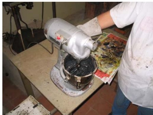
FIGURA 32. PARA UNA COMPOSICIÓN MÁS HOMOGÉNEA SE UTILIZÓ LA MEZCLADORA DEL LABORATORIO DE HORMIGÓN.
