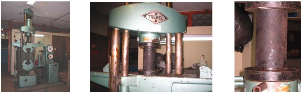
FIGURA 40. DETALLE DE LA CARGA ÚLTIMA APLICADA DE 13 TONELADAS
