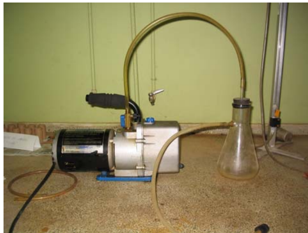
FIGURA 23. BOMBA DE EXTRACCIÓN DE VACÍOS
