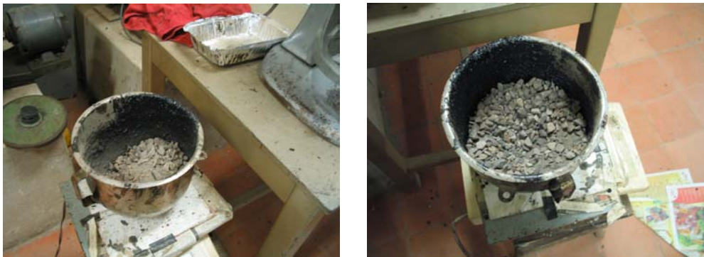
FIGURA 28. AGREGADOS PRECALENTADOS A 160°C
