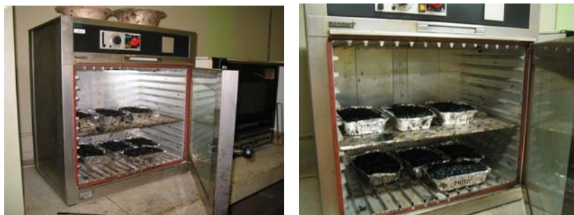
FIGURA 35. SE MANTIENE LA MEZCLA EN SU MOLDE EN EL HORNO PARA QUE NO SE ENFRÍE Y SE ENCUENTRE EN EL MOMENTO DE LA COMPACTACIÓN A 140°C
