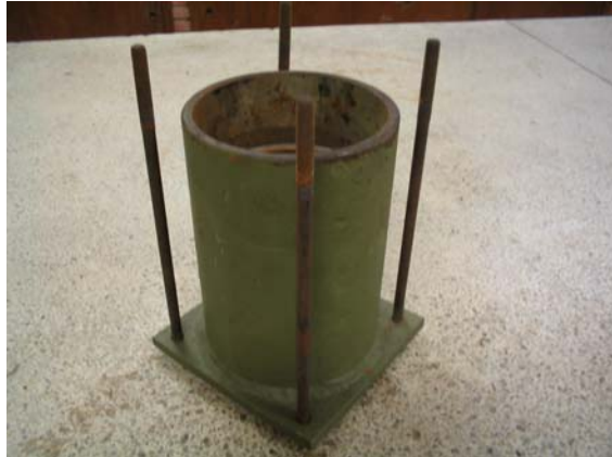
FIGURA 52. DETALLE DE LA BASE METÁLICA DEL MOLDE
