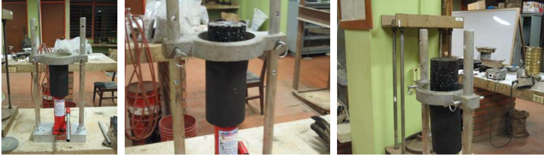
FIGURA 41. DESMOLDE DE LA PROBETA YA COMPACTADA
