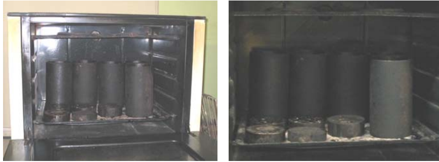
FIGURA 36. PRECALENTAMIENTO DE LOS MOLDES DE COMPACTACIÓN, A LA TEMPERATURA ADECUADA.
