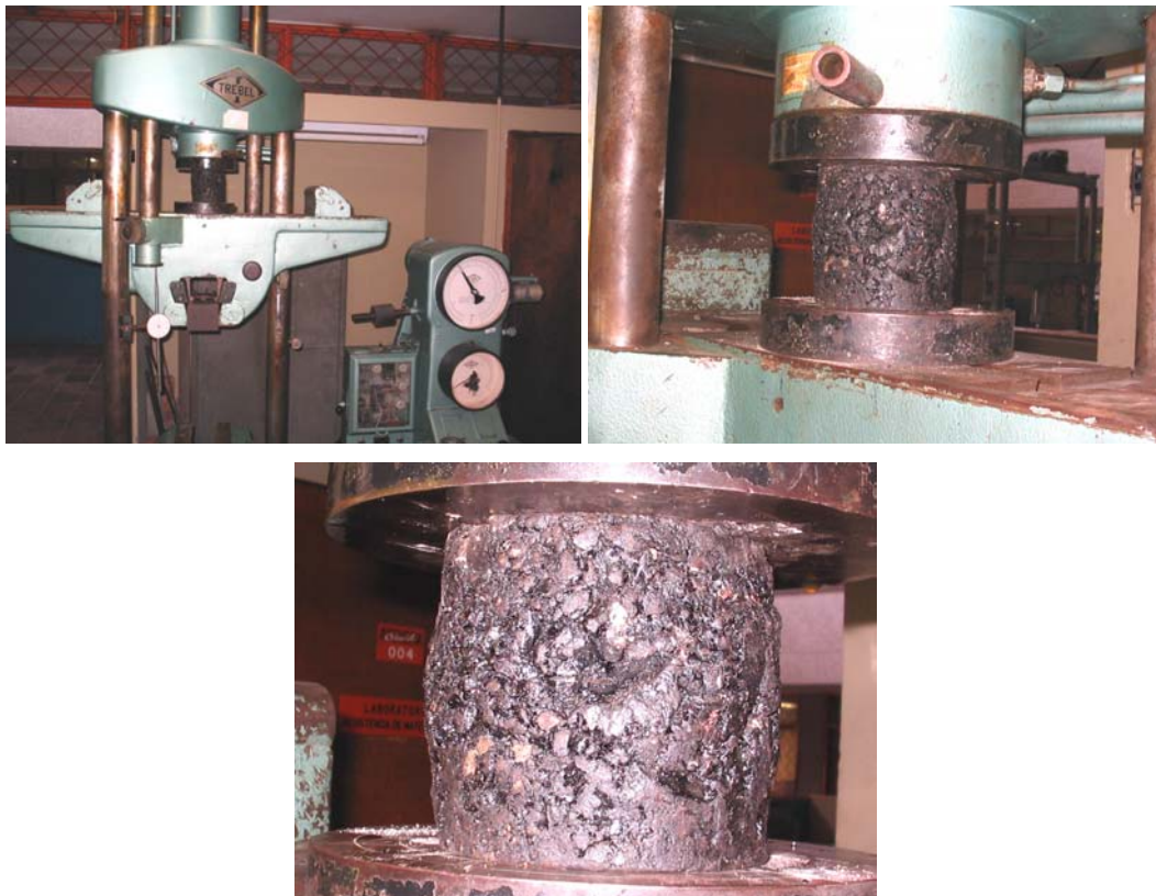
FIGURA 57. DETALLE DE LA FALLA DE PROBETAS A COMPRESIÓN SIMPLE
