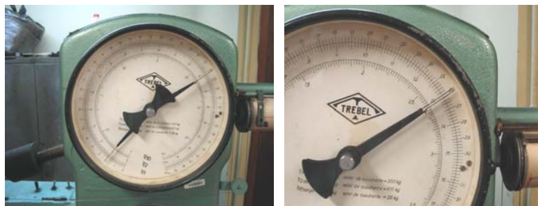
FIGURA 40. DETALLE DE LA CARGA ÚLTIMA APLICADA DE 13 TONELADAS
