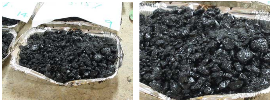
FIGURA 35. SE MANTIENE LA MEZCLA EN SU MOLDE EN EL HORNO PARA QUE NO SE ENFRÍE Y SE ENCUENTRE EN EL MOMENTO DE LA COMPACTACIÓN A 140°C
