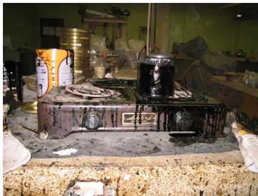
FIGURA 29. CALENTAMIENTO DEL ASFALTO A 150°C
