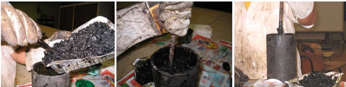
FIGURA 37. ENGRASADO DE LOS MOLDES DE COMPACTACIÓN.
