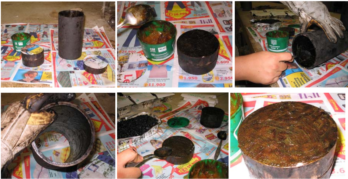
FIGURA 37. ENGRASADO DE LOS MOLDES DE COMPACTACIÓN.
