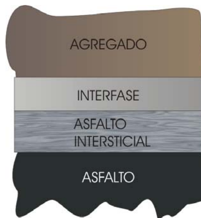
FIGURA 14. CARACTERÍSTICAS DEL ENLACE ÁRIDO-LIGANTE
