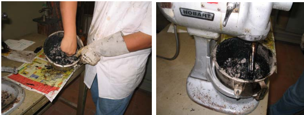
FIGURA 31. PROCESO DE MEZCLADO DE LOS AGREGADOS Y EL ASFALTO, A UNA TEMPERATURA DE 150°C
