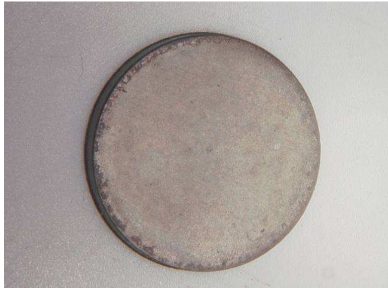
Figura 11 Probetas recubierta con cerámica bioactiva (HA) mediante precipitación directa en solución acuosa. El autor.
