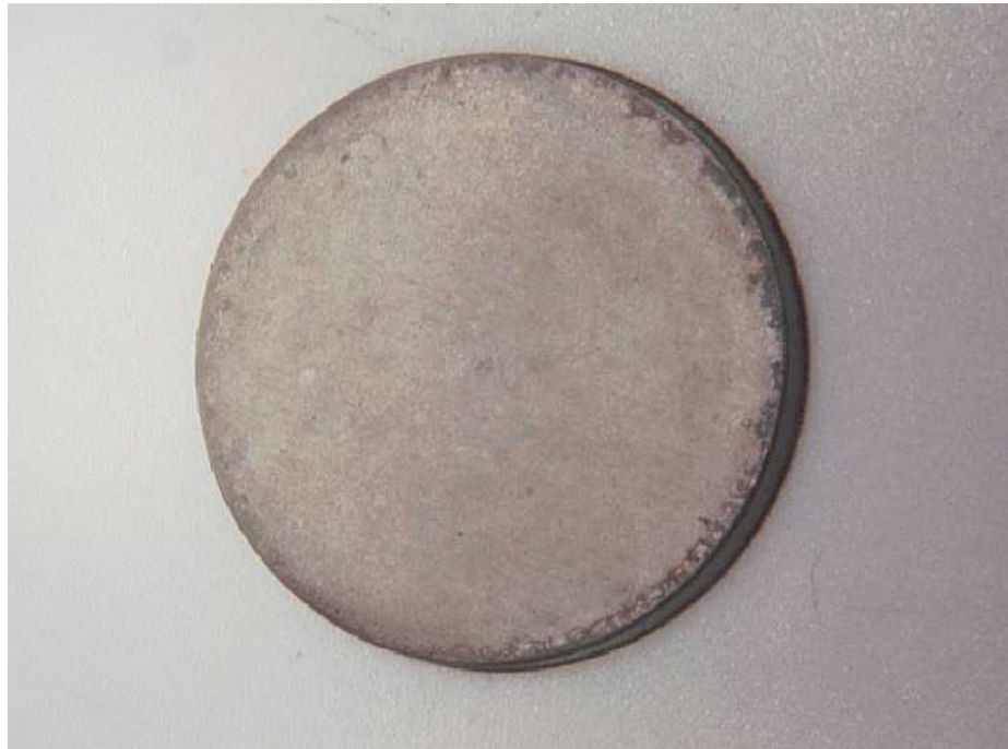
Figura 23 Probeta de Ti6Al4V-ELI. Pulida mecánicamente papel carburo de silicio #600, Recubierta con cerámica bioactiva. 20X. El autor
