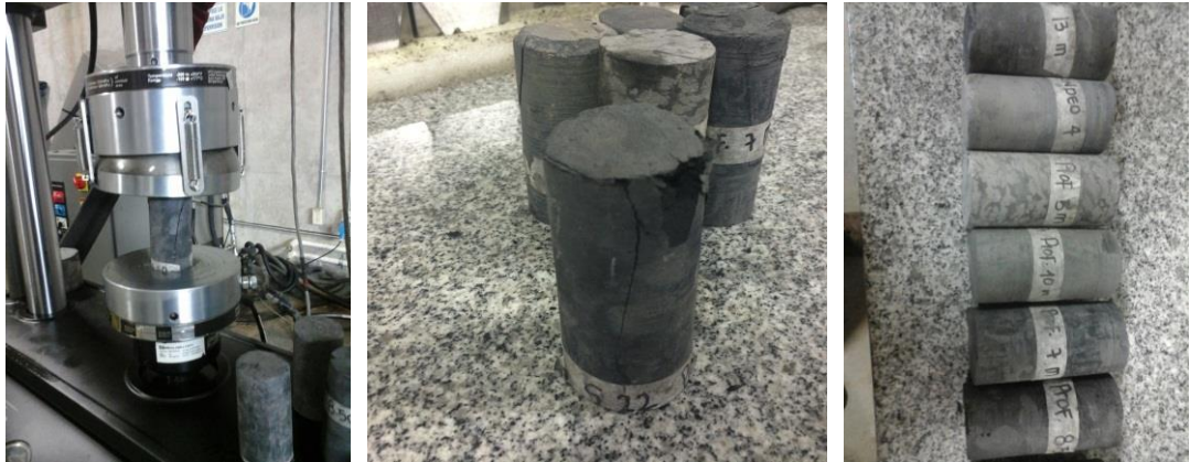
Figura 49. Vista general de los ensayos de compresión simple.
