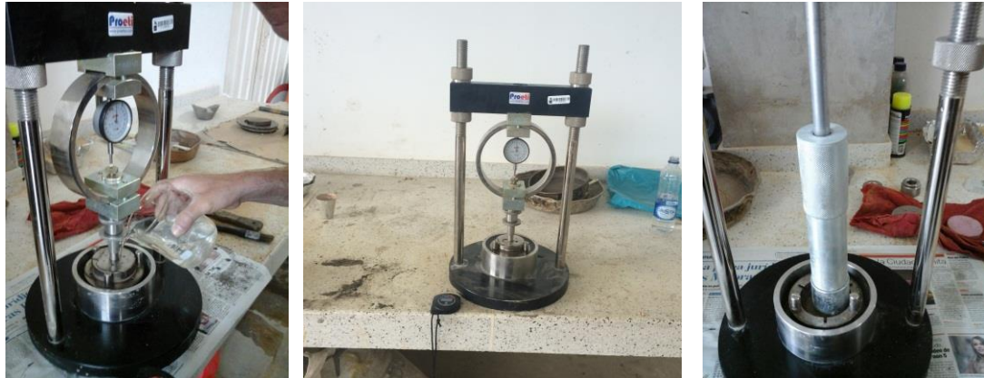
Figura 48. Vista general de ensayos de presión de expansión
