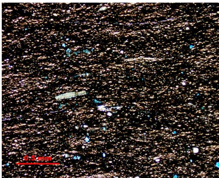
Figura 12. Fotomicrografía tomada en nicoles cruzados con objetivo de 5X. Aspecto textural del shale carbonáceo moscovítico. Se observan láminas de materia orgánica intercrecido con hojas discontinuas de micas, principalmente moscovita.
