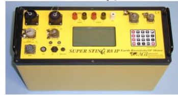
Equipo de Tomografía Geoelectrica SuperSting R8/IP/SP WiFi
