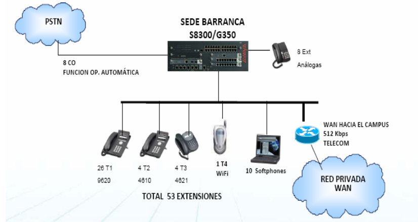
Figura 10. Red de ToIP en la UIS Sede Barrancabermeja
