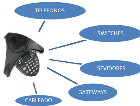
Figura 18. Elementos de la Telefonía IP
