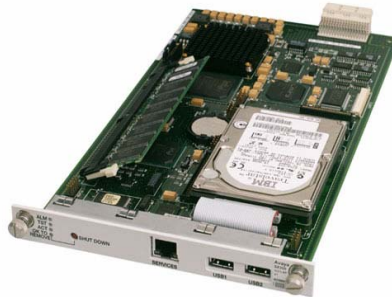
Figura 21. Servidor de Media S8300 de Avaya
