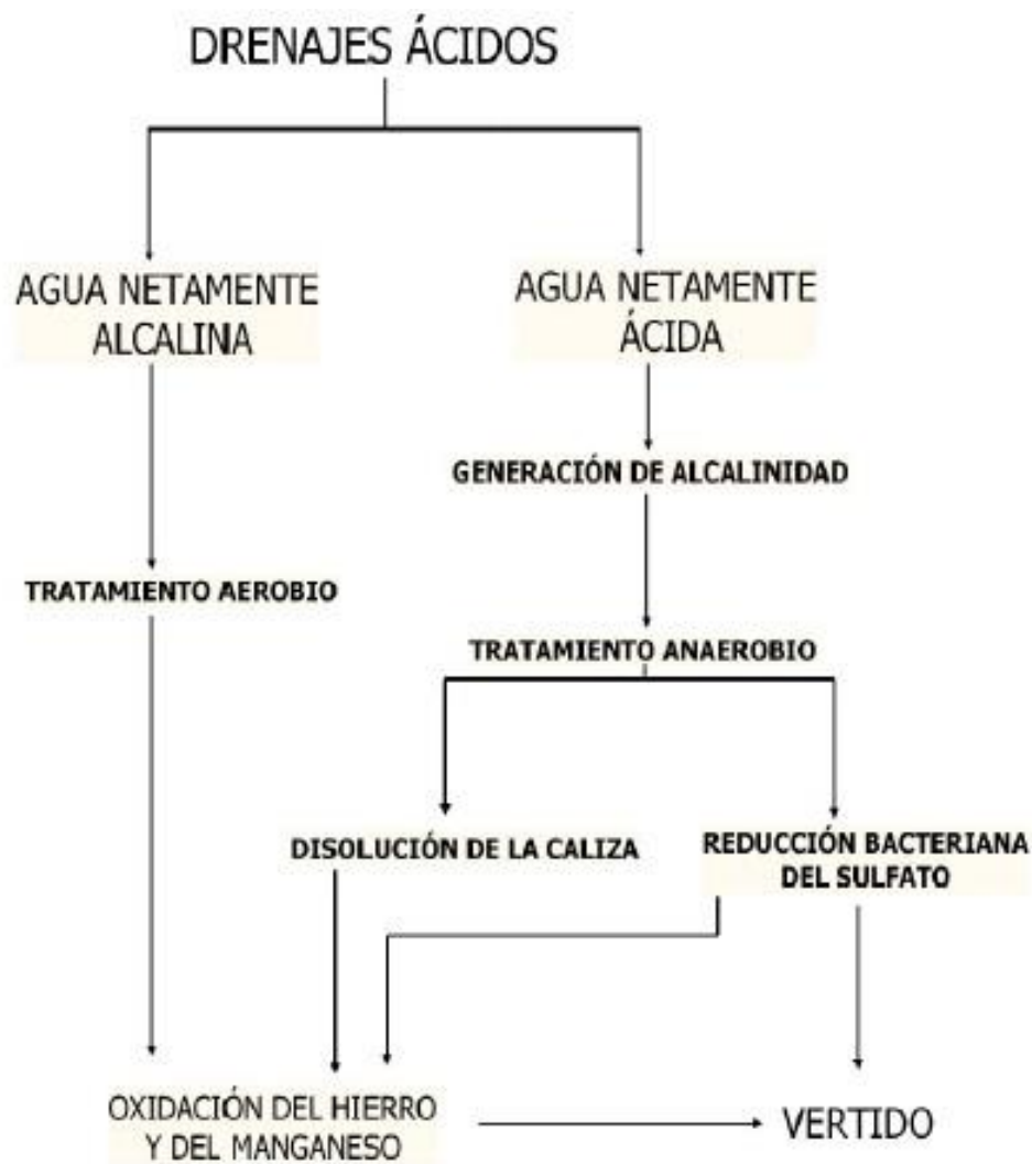
Figura 24 Secuencia de tratamiento de aguas ácidas en función a contenido de alcalinidad y acidez. (Instituto Geológico y Minero de España IGME, 1984; Teresa et al., 2015).
