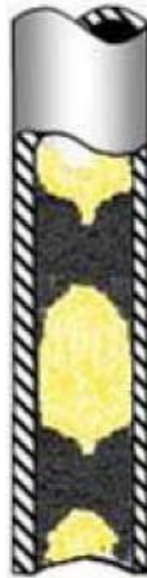
Figura 8 Flujo bache o tapón en una tubería vertical.
