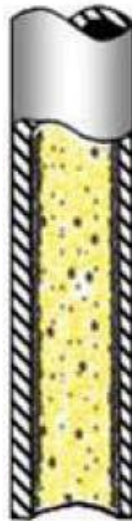
Figura 10 Flujo anular en una tubería vertical.
