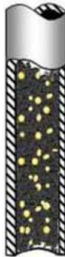
Figura 7 Flujo burbuja en una tubería vertical
