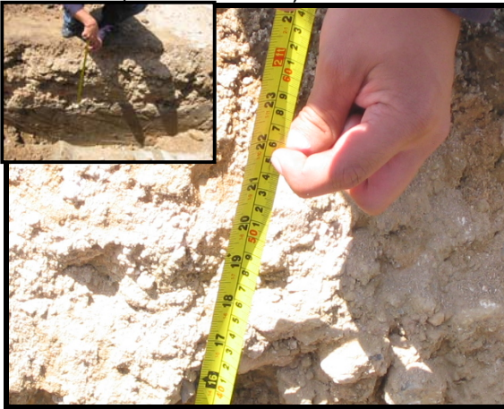
DETALLE ESPESOR DE CAPA DE SUB-BASE GRANULAR
